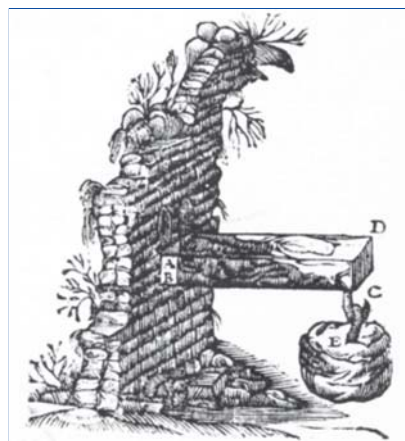
fig. 1 Resistenza a rottura di una trave a mensola caricata d'un peso alla sua estremità libera
